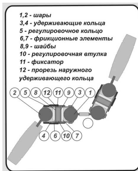
Рис. 2. Конструкция тренажера с двумя спаренными шарнирами
