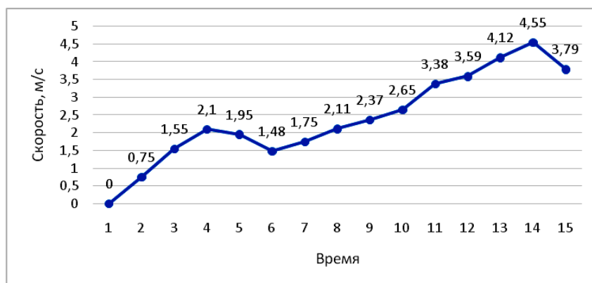
Рис. 4. Динамика скорости верхней точки упругого элемента при амплитуде движения середины стержня 0,04 м до точки торможения.
