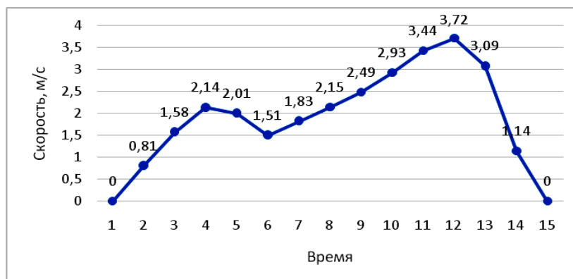
Рис. 6. Динамика скорости верхней точки упругого элемента при амплитуде движения второго маркера стержня 0,01 м до точки торможения
