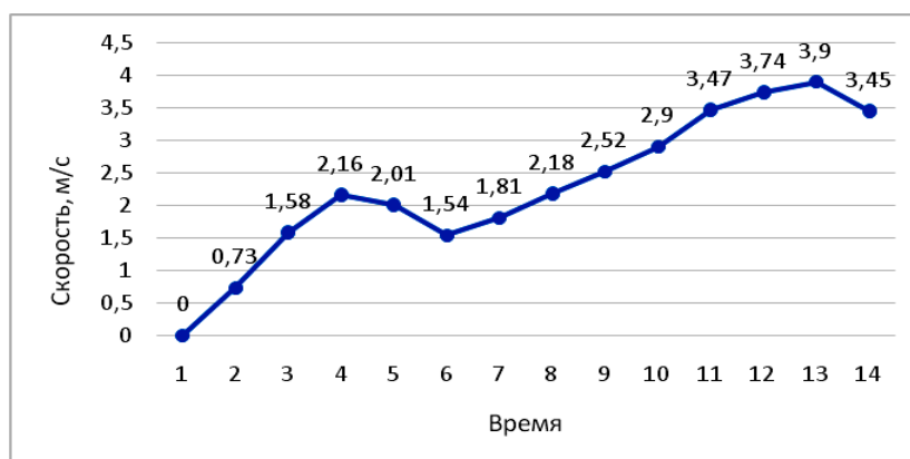
Рис. 2. Динамика скорости верхней точки упругого элемента при свободном разгибании
