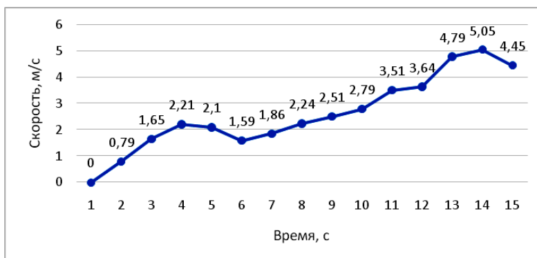
Рис. 3. Динамика скорости верхней точки упругого элемента при амплитуде движения нижнего маркера 0,02 м до точки торможения
