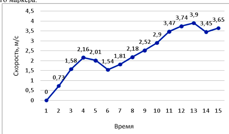
Рис. 5. Динамика скорости верхней точки упругого элемента при амплитуде движения середины стержня 0,06 м до точки торможения
