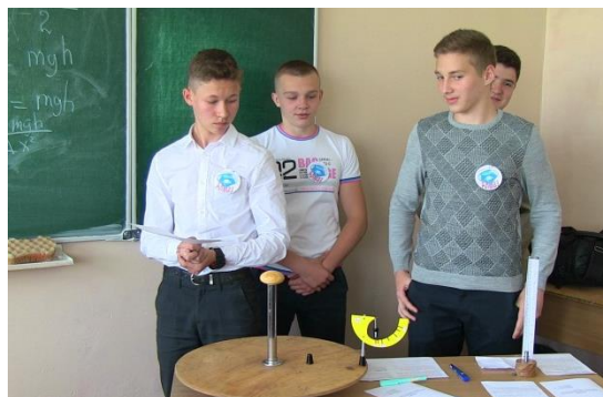
Мал 5. Прилад, за допомогою якого можна підрахувати період і частоту тіла, яке коливається або рівномірно обертається
